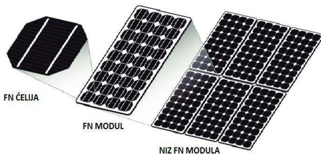
Slika 14. Spajanje FN ćelija u FN module i nizove
